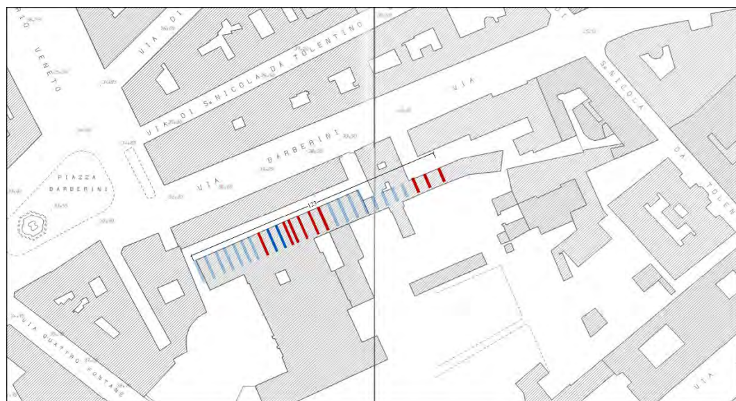
Figura 8. Planimetria con l'andamento ipotizzato delle sostruzioni verso la valle sallustiana: in rosso i resti delle murature ancora visibili, in blu i resti accertati non più visibili, in azzurro le ipotesi (elaborazione grafica di Sofia Menconero su fotopiano dell' Atlante di Roma 1991).
